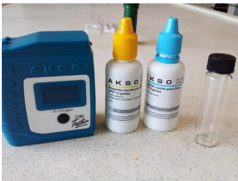
FIGURA 1 – CLORÍMETRO DIGITAL E KIT DE REAGENTES INDICADOR DPD E SOLUÇÃO TAMPÃO E CUBETA DE LEITURA.
