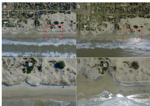
Figura 18: (a) Fotografia vertical realizada em 15 de junho de 2016 com destaque (c) para ocupação e para as dunas frontais. (b) Fotografia vertical realizada em 5 de novembro de 2016 com destaque (d) para a mesma ocupação e para o processo erosivo que removeu grande parte das dunas frontais, expondo a vegetação da frente da ocupação diretamente a ação marinha.
