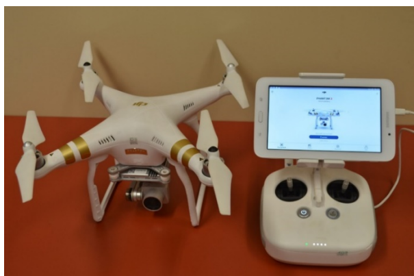
Figura 2: DJI Phantom 3 profissional e controle remoto do equipamento, com tablet acoplado.
